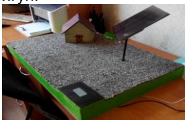
Рис. 2 Лабораторний стенд автоматичної системи орієнтації сонячної батареї
